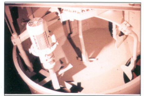
Mischsystem mit Wirbler System węzła betoniarskiego z wirownikiem. Смешивающая система с вращением
