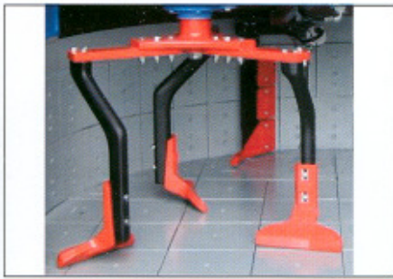
Mischsystem mit einem Mischstern und drei Mischschaufeln
